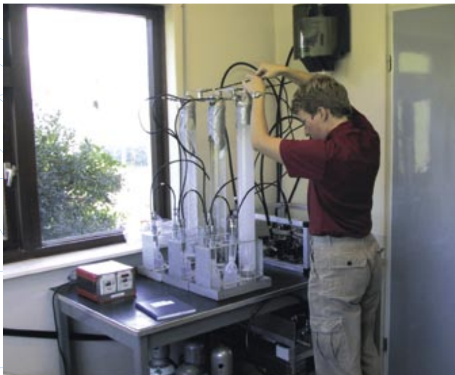
I Lutjeward, en stasjonen for atmosfæriske målinger på Nederlands kyst mot Nordsjøen, måles CO 2 -konsentrasjonen i atmosfæren hver annen uke ved å absorbere CO 2 i natriumhydroksid (lut).
