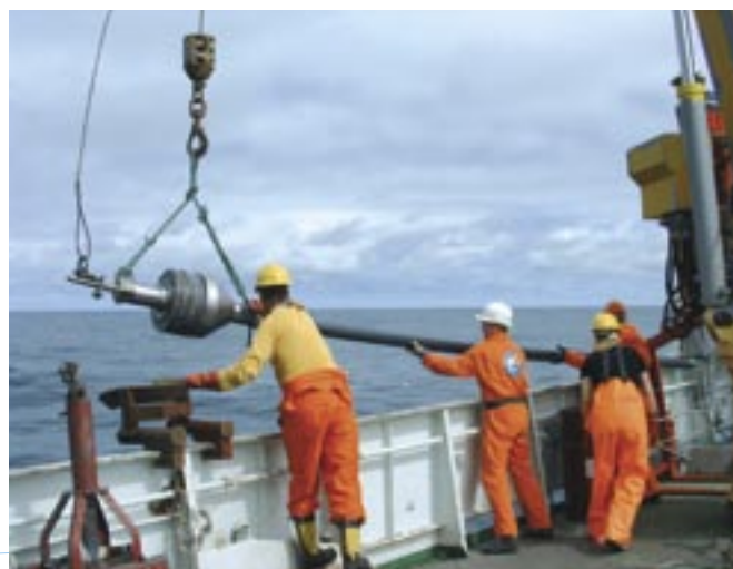
En kjerneprøvetaker slippes ut i Færøy-Shetlandkanalen fra forskningsfartøyet Håkon Mosby.
