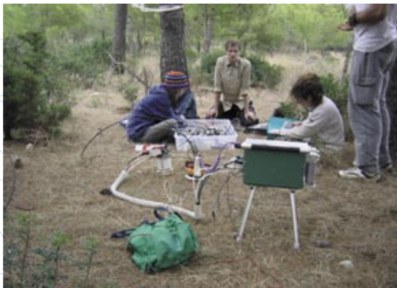
Visste du at jordsmonnet puster? Med dette instrumentet måler vi hvor mye CO 2 grunnen på Pianosa slipper ut.
